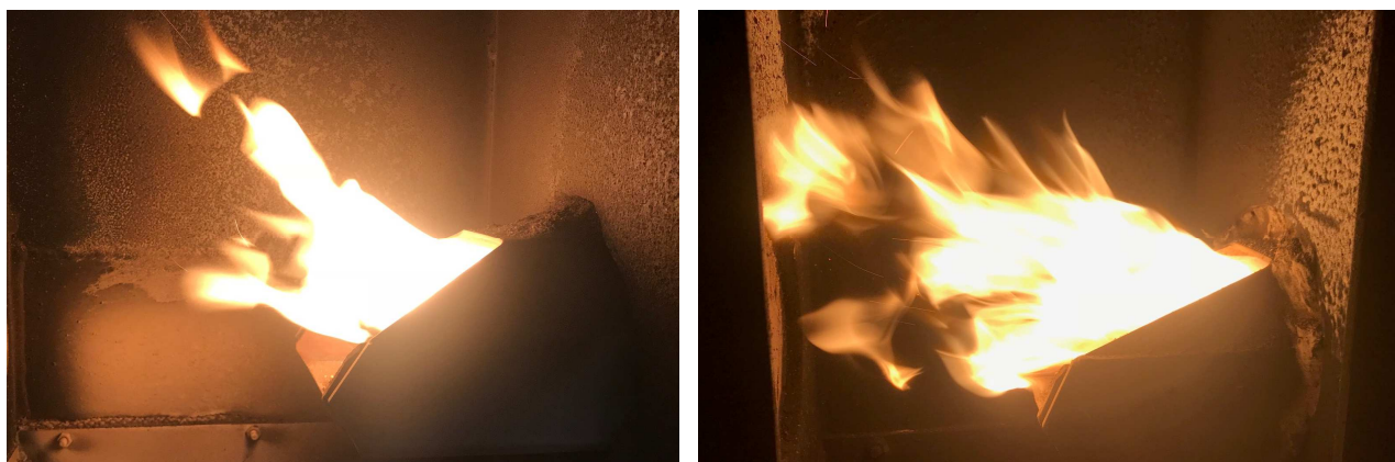
Obr. č. 34 – Tvar plamene – menší výkon vlevo a vyšší výkon vpravo
