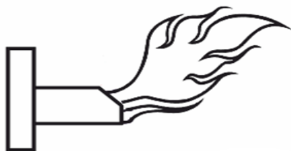
Špatně. Malý výkon ventilátoru. Mohutný a vysoký plamen.
