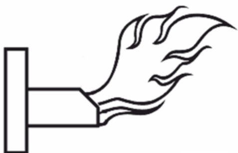
Špatně. Malý výkon ventilátoru. Mohutný a vysoký plamen.
